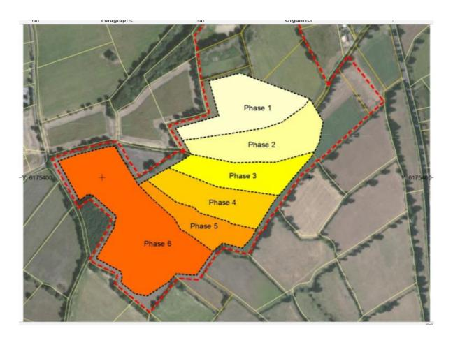
La première étape de découverte est le décapage sélectif de la terre végétale et son stockage sous forme de merlons à l'est et l'ouest de chaque phase ainsi que les stériles d'argile qui sont estimés à 41000 m3.
